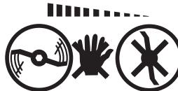
Остриетата ще продължат да се въртят след изключване на машината.
